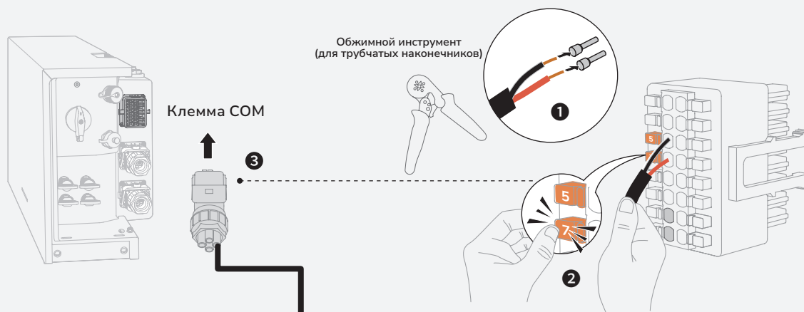
Соединение между двумя EF HD-P1-(3K-6K)-S1 при каскадном подключении
